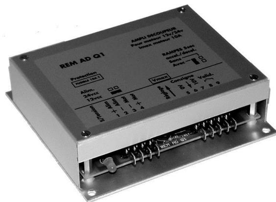
Le principe de fonctionnement du REM ADQ1 est le découpage de la tension moteur à une fréquence de 10KHz, la commande par la consigne du temps de conduction permet de régler la tension moteur et de ce fait la vitesse de celui-ci. Un réglage de gain permet d'ajuster la vitesse maximum. La résistance de sortie est  $< 0,1\Omega$ .
