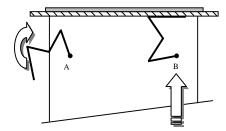
Ou positionner les ressorts contre la face avant (figure B), et les pousser jusqu'à ce que les pattes prennent place dans les trous du boîtier dessus et dessous.
