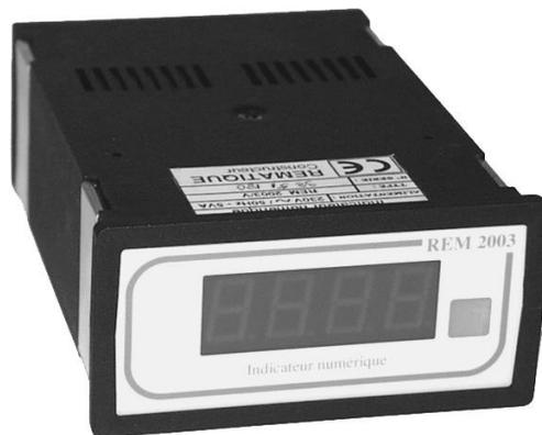
Le REM 2003/V est un indicateur numérique qui permet d'afficher sur trois chiffres plus un zéro permanent une grandeur quelconque, proportionnelle à la tension d'entrée : vitesse, débit, pourcentage, etc.
